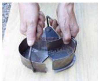
Рисунок 11 – Схема и общий вид устройства для очесывания бобов сои с растений:
