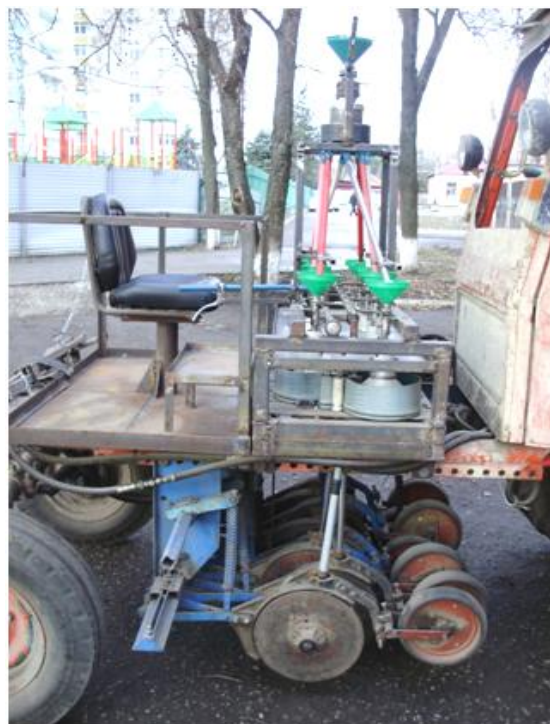
Рисунок 2 – Самоходная селекционная сеялка для посева опытных делянок льна масличного
