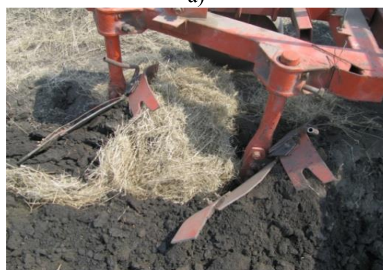
Рисунок 2 – Процесс работы сталкивателя (а) и полувинтовых плужных корпусов с углоснимками и перьями на конце отвала (б)
