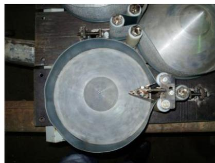
Рисунок 4 – Высевующий аппарат конусного типа
