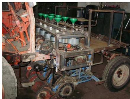
Рисунок 1 – Экспериментальный образец самоходной селекционной сеялки
