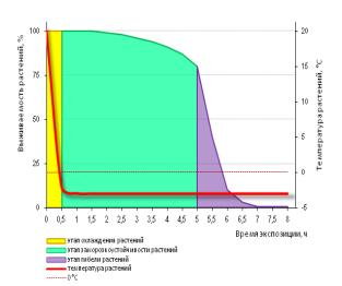
Рисунок 2 – Этапы отклика растений сои на воздействие отрицательных температур в криокамере при частном случае минус 3 °C
