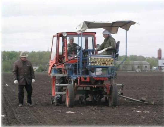
*Рисунок 2 – Селекционный посев сои кассетной сеялкой СКС-6А*
