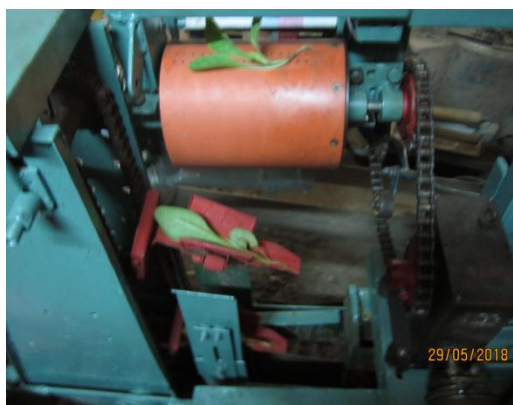
Рис. 5. Процесс подачи рассады от подающего барабана к рассадодержателям цепного посадочного аппарата
