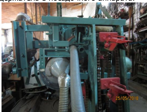
Рис. 3. Общий вид экспериментального образца рабочего органа для автоматической подачи рассады к посадочному аппарату (вид сзади)
