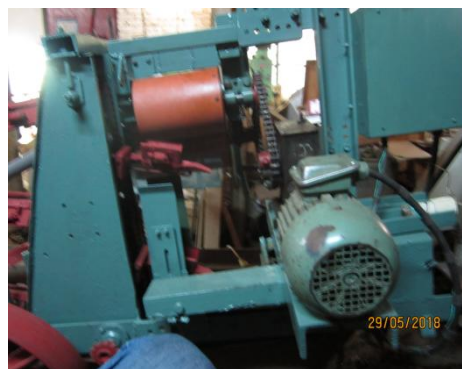
Рис. 4. Общий вид подающего барабана рабочего органа для автоматической подачи рассады и посадочного аппарата цепного типа
