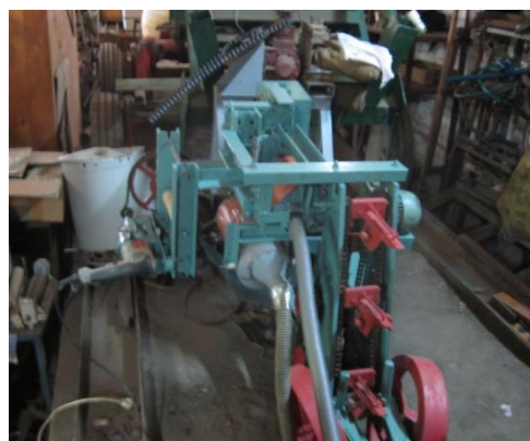
Рис. 6. Общий вид стенда для исследования параметров рабочего органа для автоматической подачи рассады к посадочному аппарату
